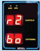
4ª opção é para alterar o nível mínimo para proteção contra entrada de ar na tubulação ou nível mínimo para marcar a reserva de incêndio.
