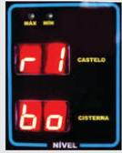
3ª opção é para alterar o nível mínimo e máximo de acionar ou desligar a bomba.
