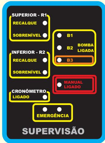
**Módulo de supervisão** : é parte básica da placa mãe e disponibiliza 16 Leds que mostram a situação do sistema, e a situação dos detectores dos reservatórios. O detector de recalque informa se a água está entrando no reservatório, o detector de sobrenível é uma segurança extra que informa se há algum erro no sistema com risco de transbordo. O detector de água da rede informa se existe água da rede entrando.
